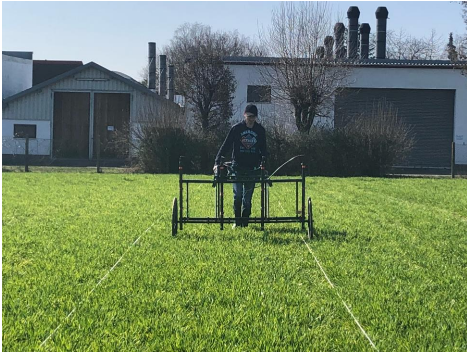
Abb. 1a: Foerster Ferex 4.032 in Quadro-Sensor-Anordnung auf Rädern (Photo: S. Ostner).
