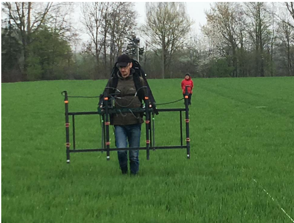
Abb. 1b: Foerster Ferex 4.032 in Quadro-Sensor-Anordnung getragen (Photo: M. Scheiblecker).
